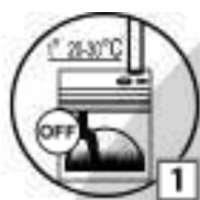
Шаг 1. Погасить горелку оборудования, дать остыть оборудованию до t° 20-30°С.
